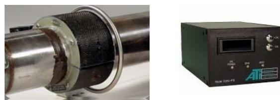
**功能:** 通过无线测量测量高速旋转轴的扭矩。
