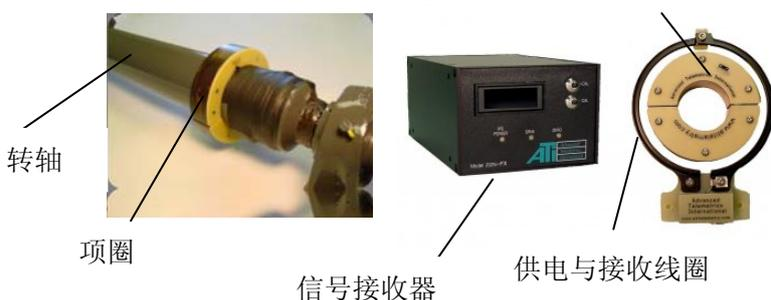
**项圈:** 用于安装于转动轴上，内置微型采集与发射模块，采集应变片等传感器信号。有多种规格可选，最小直径 3.6mm。原理图:
