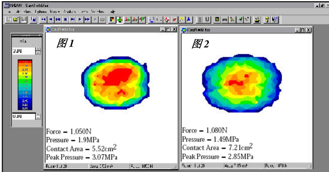
选择一个合适的滑轮，能够轻易的滚动而不伤害地砖或地毯，是个独一无二的挑战。这边便利用不同的4张图来为您比对4种不同滑轮的影响。图1和图2为两组单轮分别承受了相近的力量，同样地图3、图4则分别为承受相近力量的两组双轮。将 Tekscan 如纸一般薄(0.004 吋)、内含 2,000 个感测组件的感测片置于样品地板上，并以可计算机操控负载之滑轮压在感测片和地板上，接着便可记录、分析与比对滑轮与地板间的接触压力。
